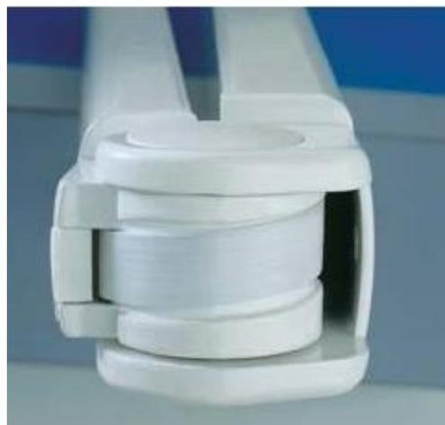
Brazo con sistema de tensión interno incorporado, tipo ART- System. Este sistema patentado, se compone de una cinta plana flexible que garantiza los 60.000 ciclos de funcionamiento, frente a los 3.000 exigidos en la legislación vigente.
