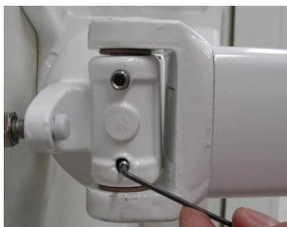
Inclusión en la tapeta del brazo de un espárrago allen que permite el ajuste de la altura del codo, actuando sobre la verticalidad del pasador.
